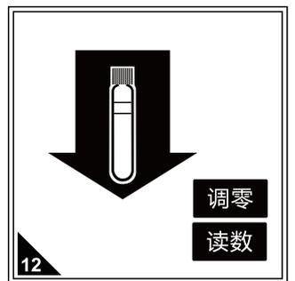
先放入空白样，按调零进行置零操作。再放入待测水样，按读数直接读取总铬元素浓度(mg/L)，期间无需开瓶盖，确保试剂为澄清状态，如有浑浊产生则不能进行读数。
