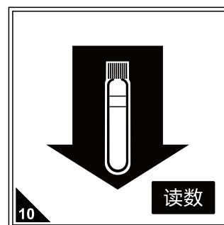
再放入待测水样，按读数直接读取亚硝酸盐浓度(mg/L)，期间无需开瓶盖，确保试剂为澄清状态，如有浑浊产生则不能进行读数。
