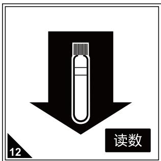
再放入待测水样，按读数直接读取镍元素浓度(mg/L)，期间无需升瓶盖，确保试剂为澄清状态，如有浑浊产生则不能进行读数。
