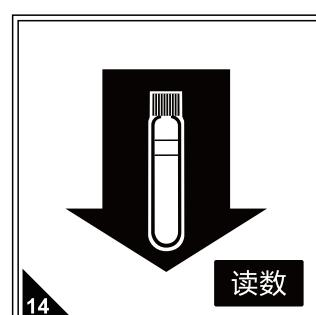
再放入待测样，按读数直接读取总磷浓度 (mg/L以“P”计)，期间无需拧开瓶盖，必须保证试剂为澄清状态，如有浑浊产生则无法进行读数。
