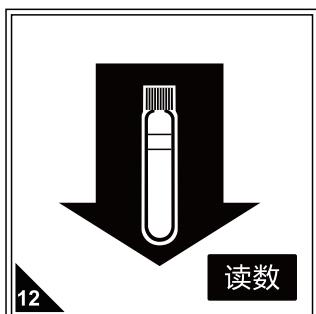
再放入待测水样，按读数直接读取氨氮浓 (mg/L以“N”计)，间无需开瓶盖，确保试剂为澄清状态，如有浑浊产生则不能进行读数。
