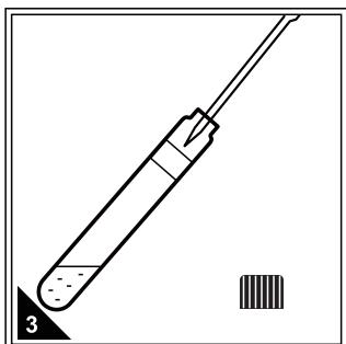
使用移液管或移液枪准确移取一定体积的无氨水加到预制试剂内制成空白样。
