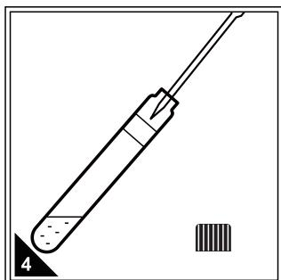
按步骤3的方法移取同体积的待测水样加入到其他预制试剂的试管内，每支预制试剂对应一个待测水样，制成待测样，记录试管上的编码。
