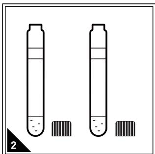
选择合适数量的预制试剂，一支作为空白样，再根据待测水样的数量选择相同数量的预制试剂作为待测样，拧开试管盖，置于试管架上。
