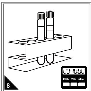
加入试剂B的氨氮预制试剂放在试管架内，使其反应并准确计时10分钟。
